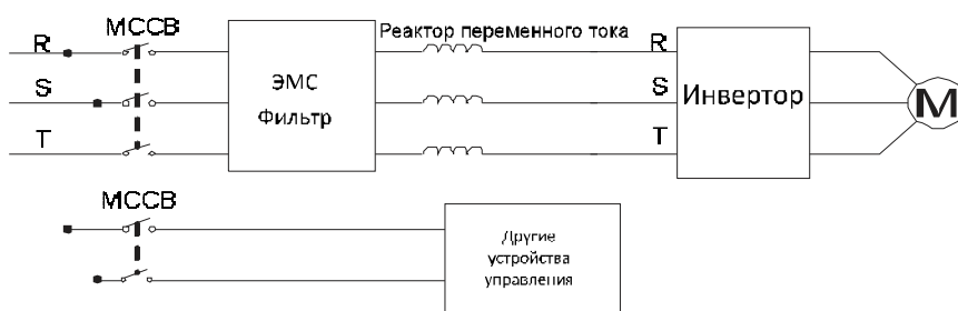
Рисунок 4.7. Подключение на первичной стороне
