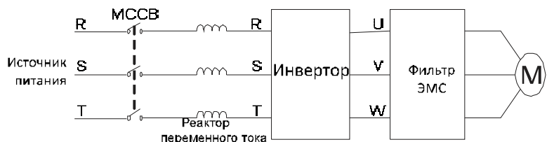
Рисунок 4.8. Подключение со стороны двигателя
